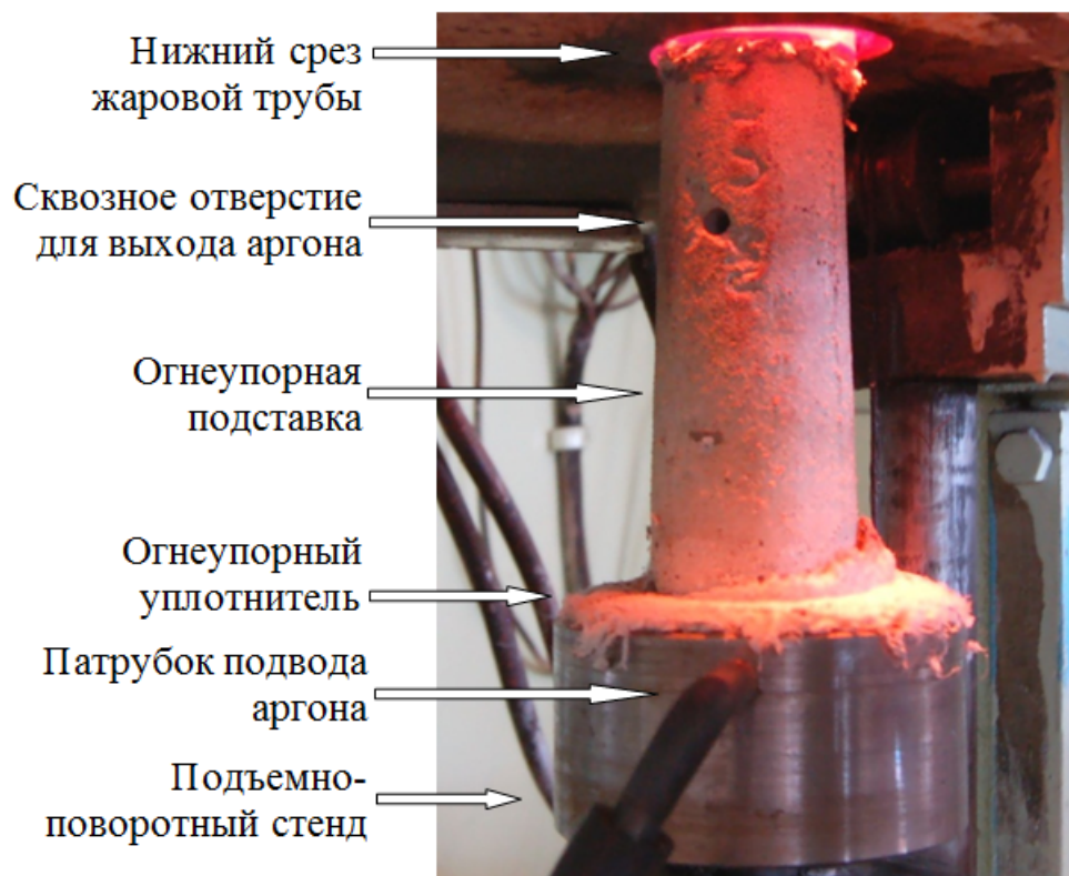
Рисунок 4 – Оснастка для ввода тигля в печь
