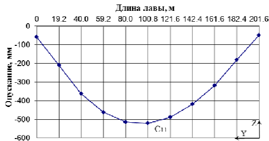
Рисунок 6 – Изменения величин опускания второго слоя кровли по взаимоперпендикулярным плоскостям, проведенным соответственно через точки С7 (а), С9 (б) и С11 (в)
