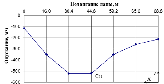
Рисунок 6 – Изменения величин опускания второго слоя кровли по взаимоперпендикулярным плоскостям, проведенным соответственно через точки С7 (а), С9 (б) и С11 (в)
