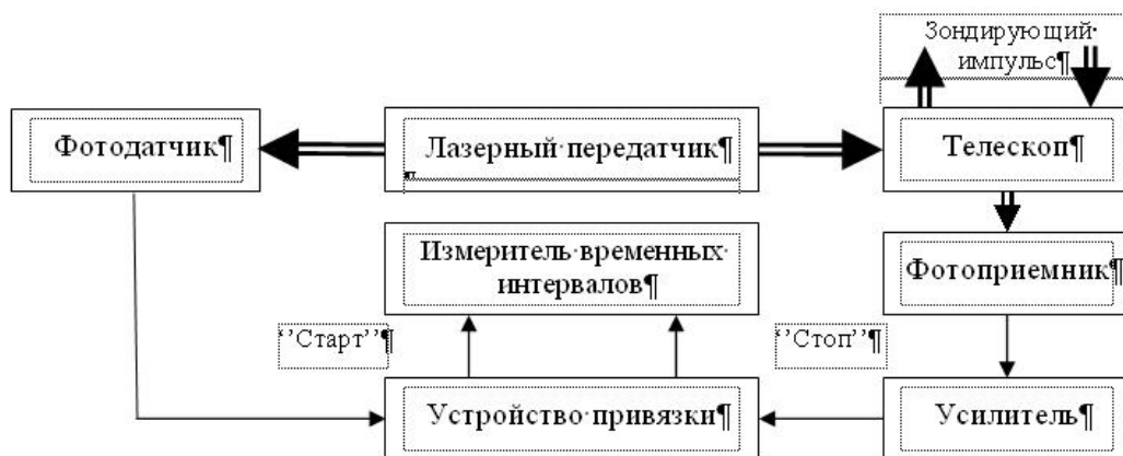
Рисунок 1 – Упрощенная структурная схема прохождения сигнала в лазерном дальномере ЛЛС
