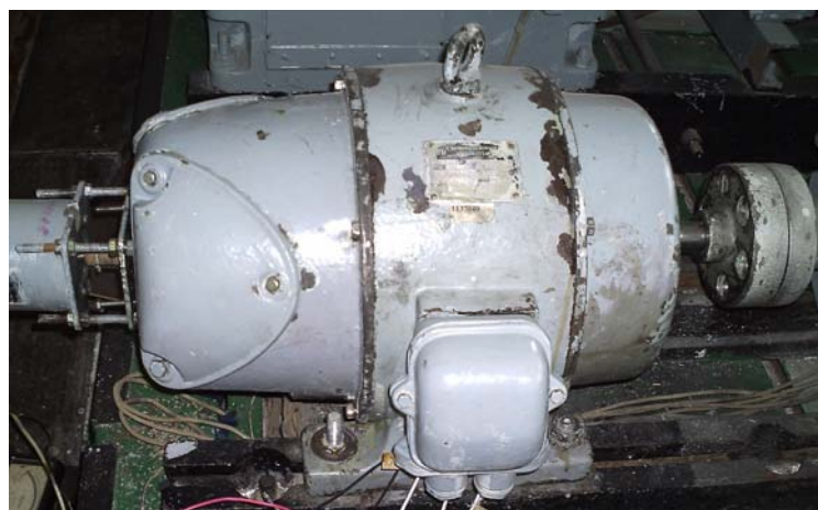
Рисунок 2 – Одномагнітопровідна синхронна каскадна машина з суміщеними обмотками
