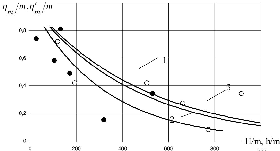
1,2 – усредняющие кривые, соответственно для зависимостей  $\eta_m/m=f(H/m)$  и  $\eta'_m/m=f_1(h/m)$ ; 3 – усредняющая кривая, рассчитанная по результатам совместной обработки всех экспериментальных данных; ○ – среднегрупповые экспериментальные данные для зависимости  $\eta_m/m=f(H/m)$ ; • – то же для  $\eta'_m/m=f_1(h/m)$ .
