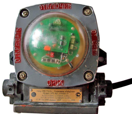
Рисунок 2 – Считыватель, предназначенный для бесконтактного дистанционного считывания идентификационных номеров RFID-метки
