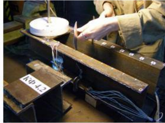
Рисунок 2- Проведение эксперимента: разрезание колонны (слева) и замер положения ветвей колонны после разрезки
