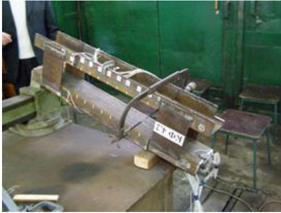
Рисунок 2- Проведение эксперимента: разрезание колонны (слева) и замер положения ветвей колонны после разрезки
