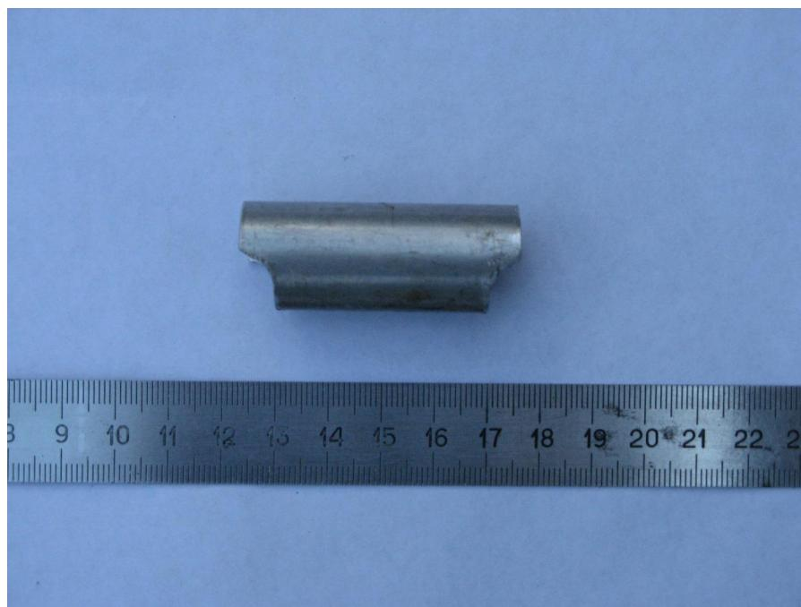
Рисунок 2 – фотография заготовки длиной 50 мм
