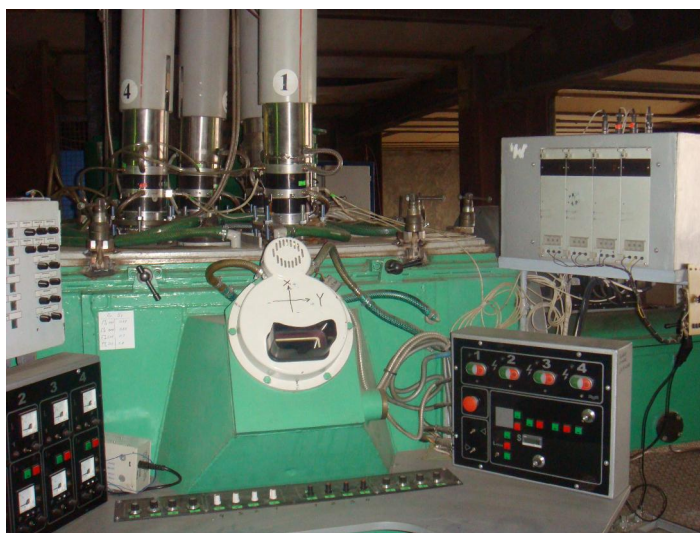
Рисунок 1 – Электронно-лучевая установка МВ-1: пульт управления и 4 электронные пушки
