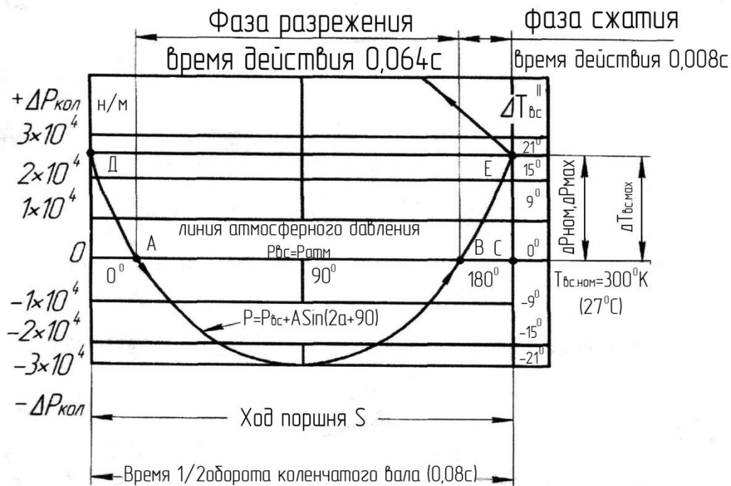
Рисунок 2 – Изменение давления и температуры в С.Т.В. первой ступени компрессора ВП-50/8М при резонансных колебаниях давления воздуха во всасывающем трубопроводе за время половины оборота коленчатого вала ( n = 375 \frac{\text{об}}{\text{мин}} ; клапаны прямоточные типа ПИК; температура воздуха T_{\text{вс.ном}} = 300^\circ \text{K} ).
