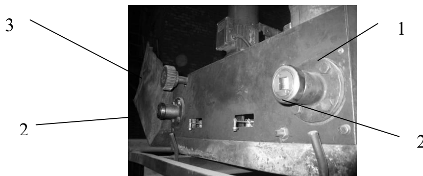
Рисунок 2 – Тележка газорезки, установленная на ремонтном стенде
