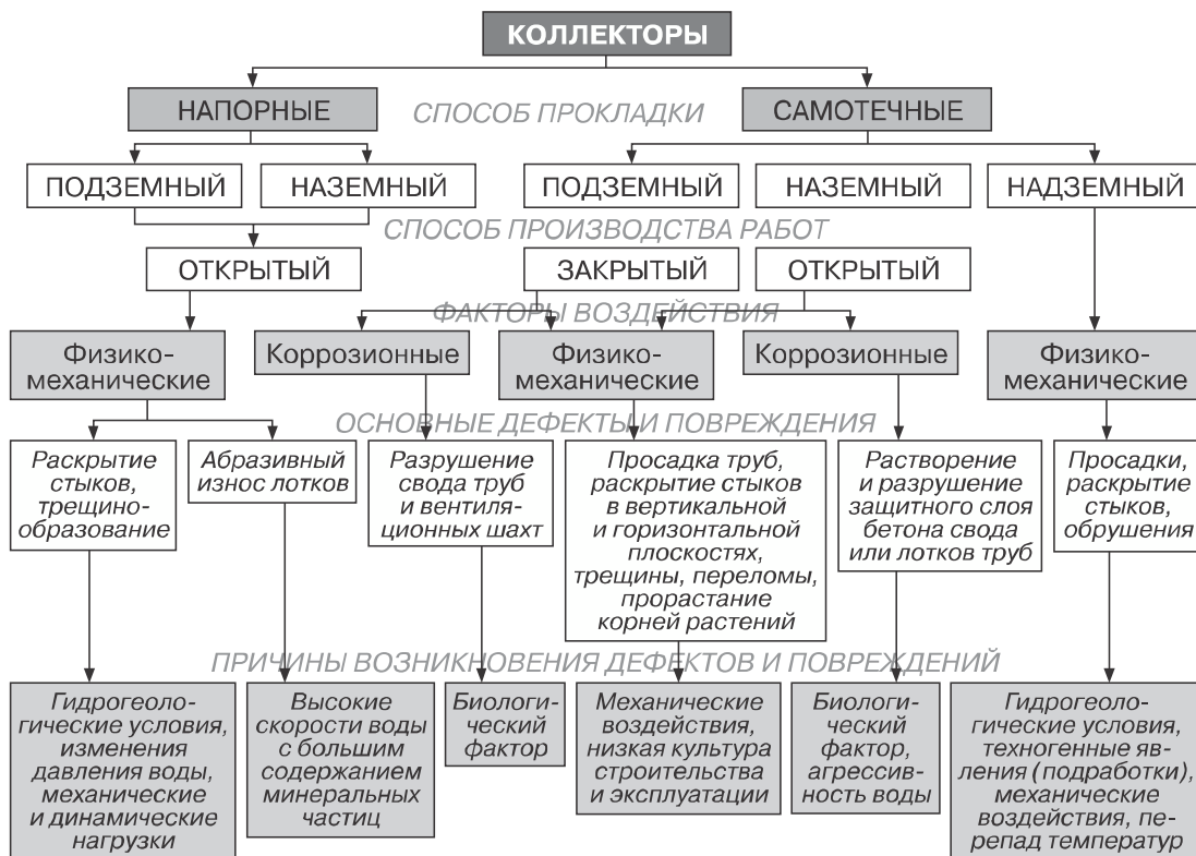
Рис. 3. Классификация канализационных коллекторов и причин их повреждений
