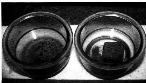
Рис. 8 Вид нефлюатированного (слева) и флюатированного (справа) образцов бетона после 12 месяцев испытания в 0,001N растворе серной кислоты (pH=3).
