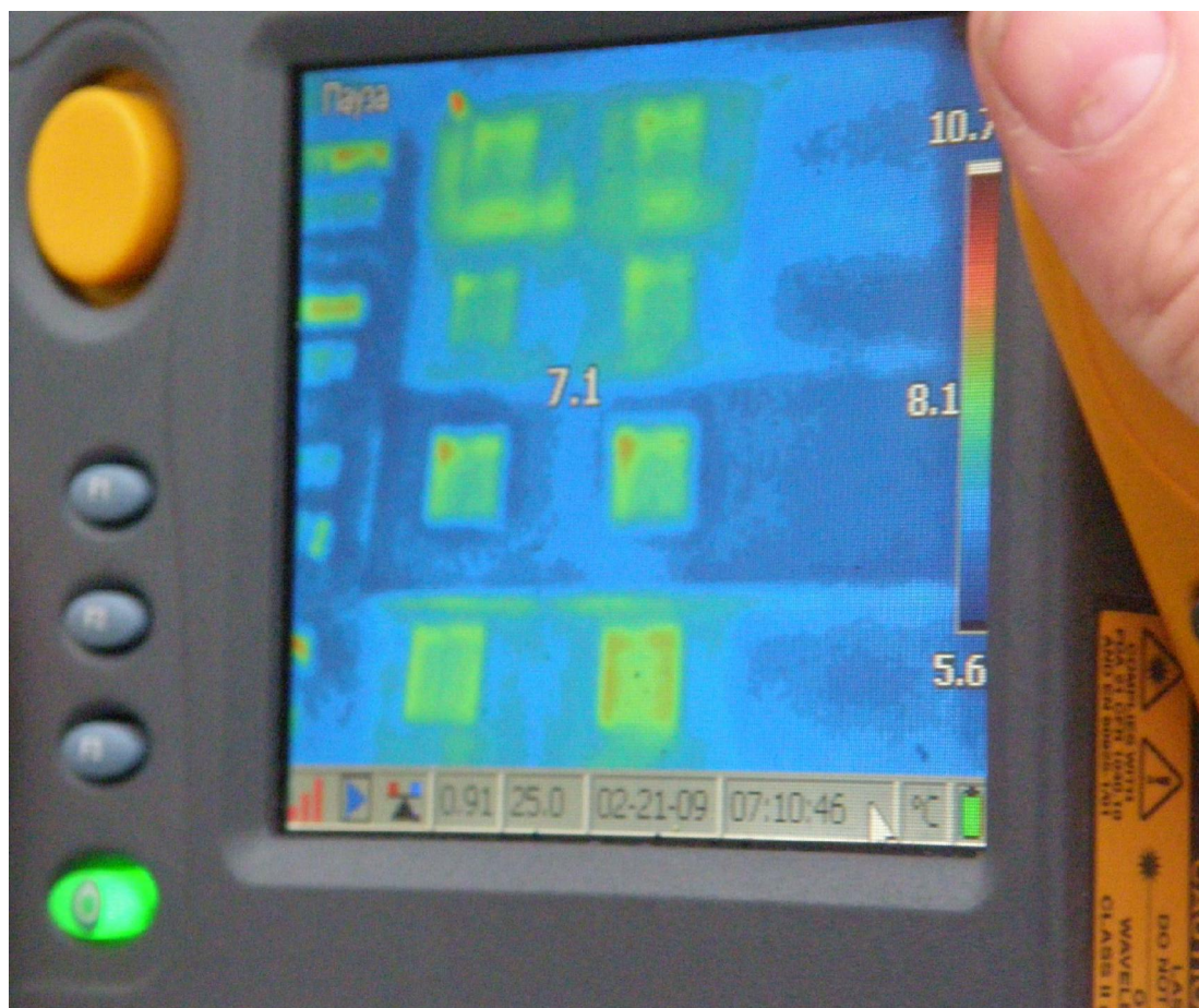
Рисунок 2 – Тепловизионный снимок жилого дома в режиме реального времени
