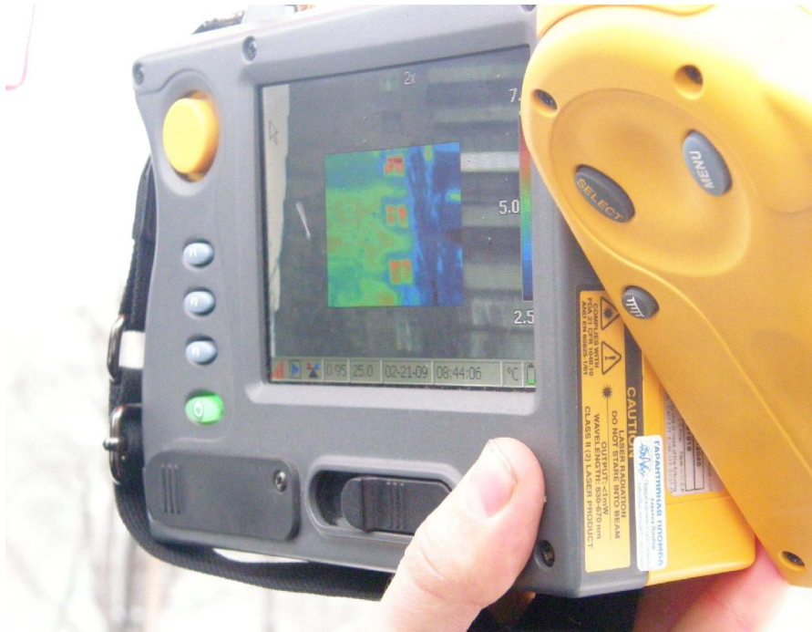
Рисунок 3 – Тепловизионный снимок жилого дома в режиме «картинка в картинке»
