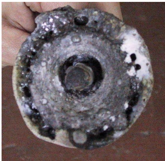
Рисунок 4 – Торец восстановительного блока после сжигания
