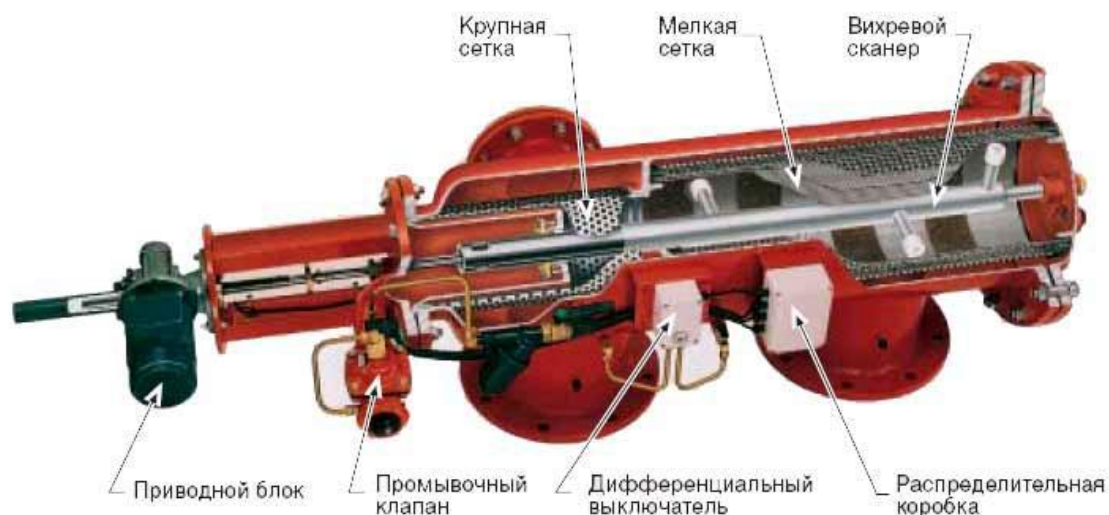
Рисунок 6 – Фильтр SAF Amiad оснащенный винтовым промывочным устройством с несколькими промывными головками
