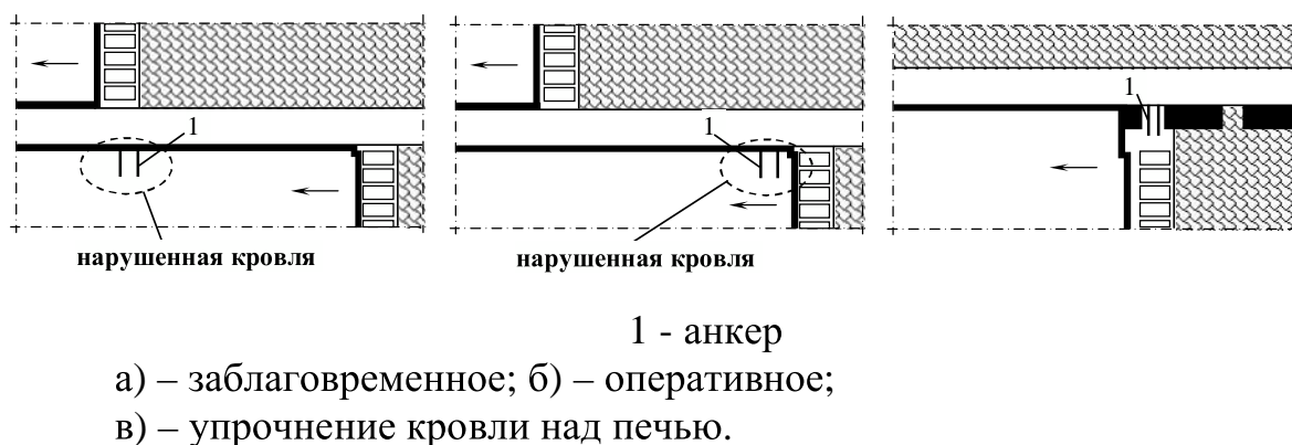
Рисунок 1 – Схемы упрочнения кровли
