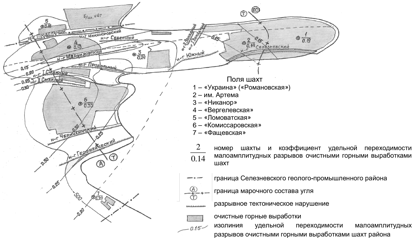
Рисунок 1 – Прогнозная карта изолиний удельной переходимости малоамплитудных разрывов угольного пласта l_6 очистными горными выработками шахт Селезневского геолого-промышленного района
