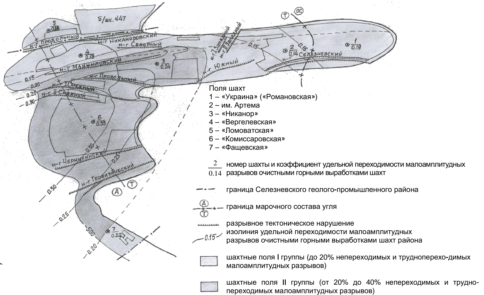
Рисунок 2 – Прогнозная карта переходимости малоамплитудных разрывов угольного пласта l_6 очистными горными выработками шахтных полей I и II групп
