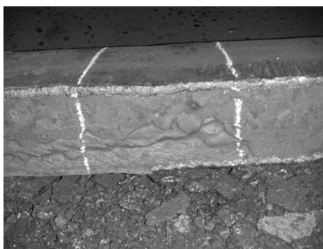
Рисунок 1 – Внешний вид дефекта «пояс» на участке сляба
