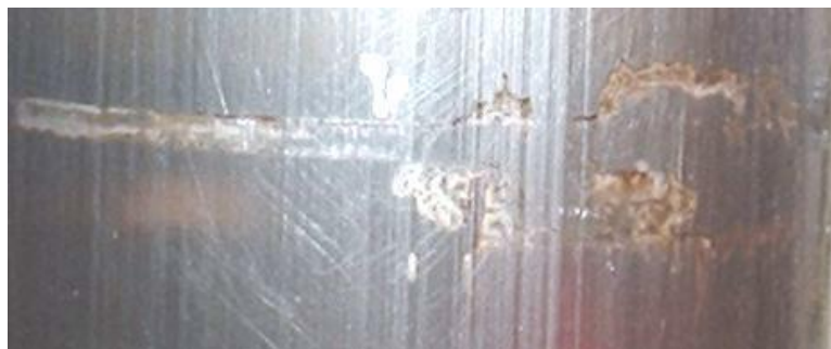
Рисунок 5 – Начальный вид изношенной поверхности со следами осповидного выкрашивания
