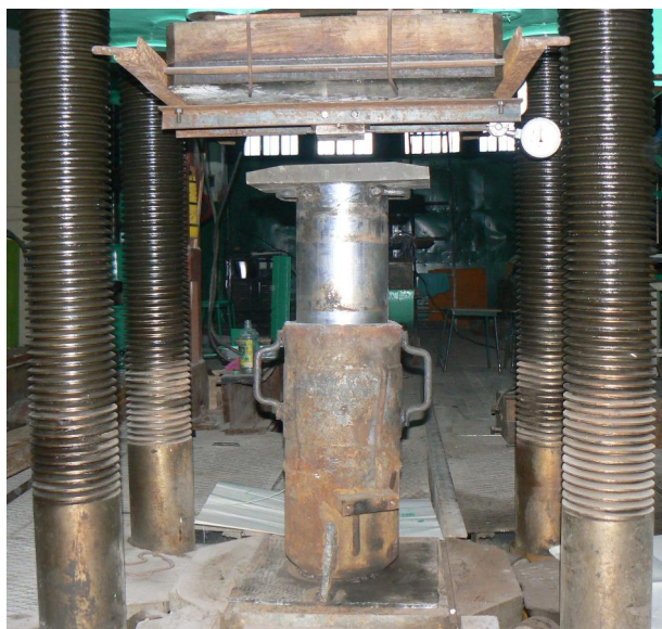
Рисунок 1 – Лабораторные испытания усадки разрушенных пород под давлением
