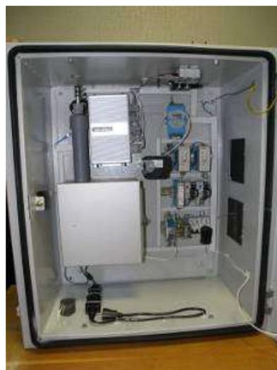
Рисунок 2 — Шкаф измерения поста контроля ШКК К-2040
