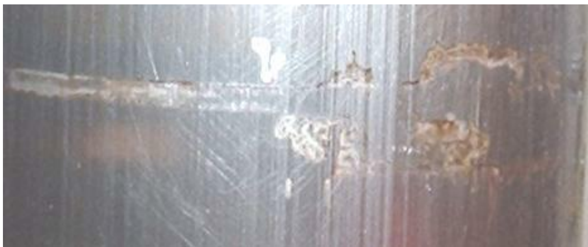
Рисунок 5 – Начальный вид изношенной поверхности со следами оксидного выкрашивания
