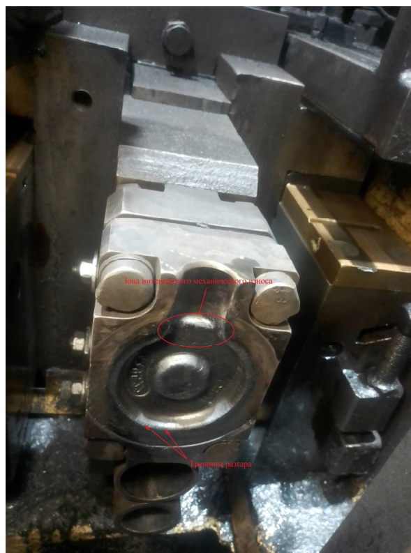
Рисунок 2 — Изношенная формовочная матрица на ГКМ
