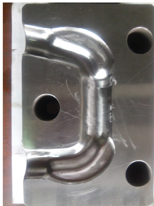
Рисунок 6 — Наплавка чеканочного штампа электродами ОЗШ-3
