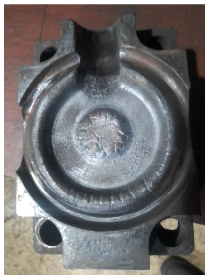
Рисунок 9 — Третья стадия износа
