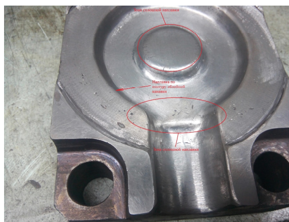
Рисунок 5 — Третья наплавка формовочной матрицы ГКМ электродами ОЗШ-3
