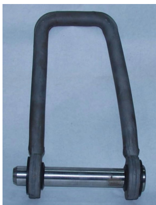
Рисунок 1 — Подвеска триангеля в сборе
