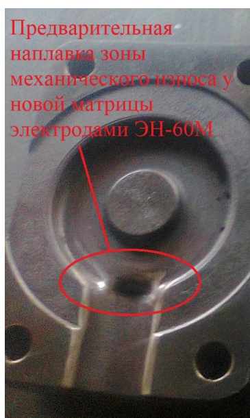
Рисунок 4 — Наплавленная электродами ЭН-60М формовочная матрица ГКМ
