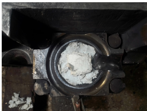
Рисунок 7 — Подготовка под наплавку
