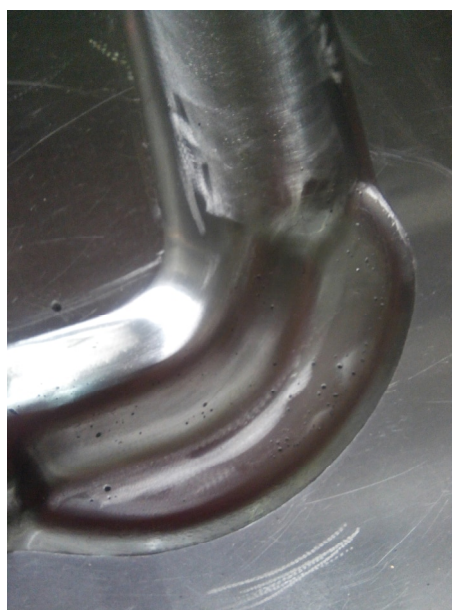
Рисунок 8 — Газовая пористость после наплавки ОЗШ-3
