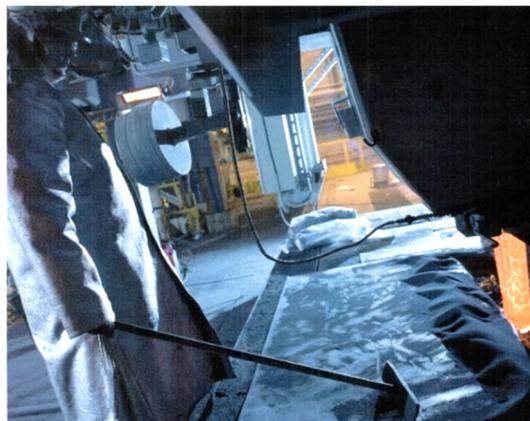
Рисунок 1 — Подача шлакообразующей смеси в кристаллизатор МНЛЗ вручную
