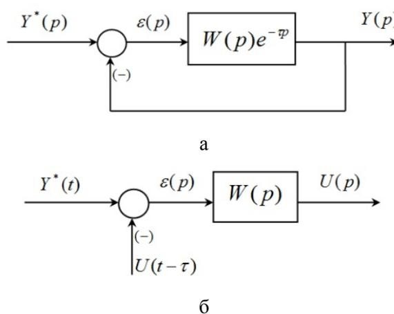
Рисунок 1 — САУ с запаздыванием (а) и разомкнутая часть САУ без запаздывания (б)
