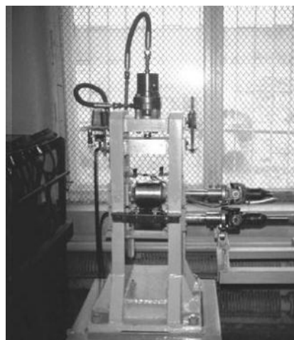
Рисунок 3 – Общий вид оборудования лабораторного прокатного мини-стана 100х100 Г Донбасской государственной машиностроительной академии
