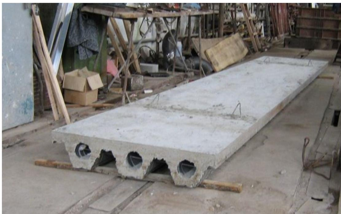
Рисунок 3 — Плита пролетом 6 м после изготовления и распалубки
