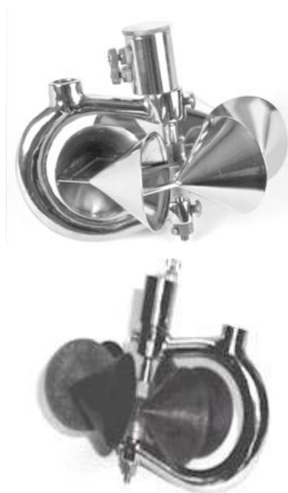
Рисунок 5 Вертушка Прайса USGS TYPE AA-ICE MODEL 6240, USGS TYPE AA-ICE-P MODEL 6245
