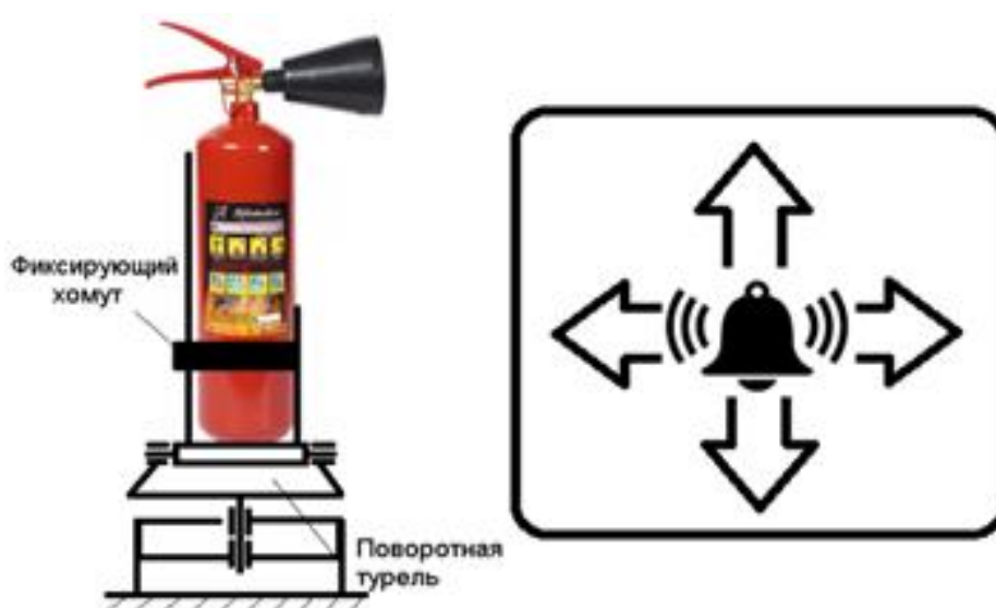
Рисунок 1 — Расположение огнетушителя на поворотной платформе и организация дисплея
