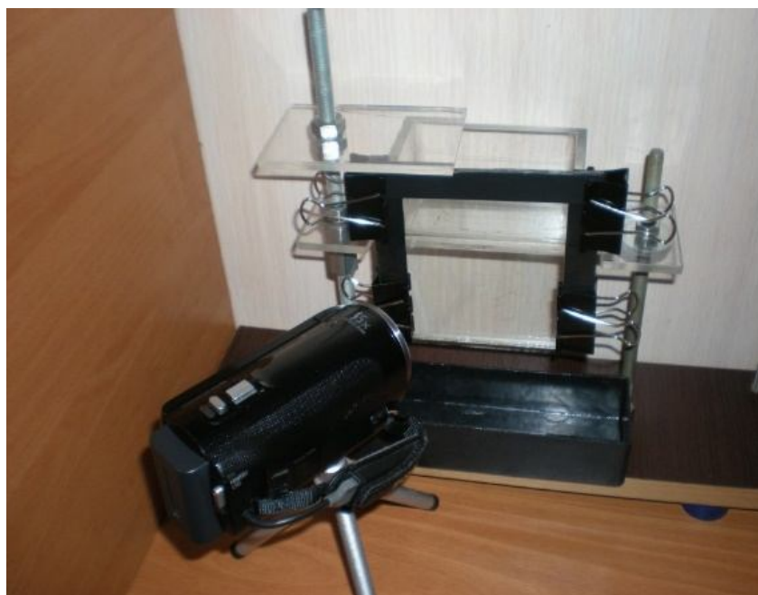
Рисунок 1 — Физическая модель для исследования поведения ШОС и НВ в зазоре
