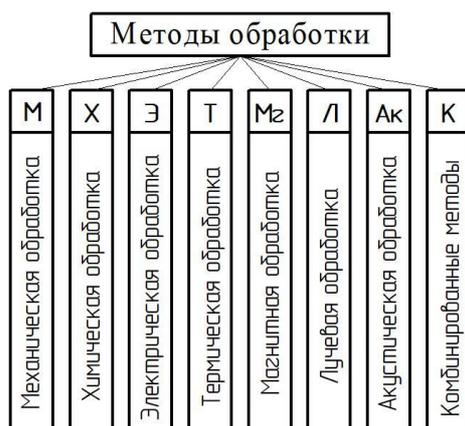
Рисунок 1 — Классификация методов обработки по виду затрачиваемой энергии
