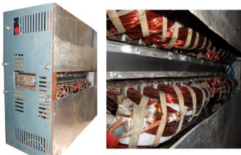
Рисунок 2 — Внешний вид физической модели электромагнитного измельчителя и устройство обмоток, создания магнитного поля
