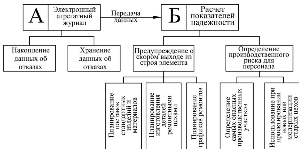
Рисунок 1 — Схема описания системы прогнозирования отказа оборудования
