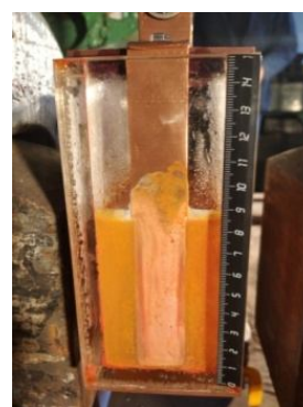
Рисунок 3 Общий вид электролита после обработки (а) и анод, находящийся в АЗ (б)
