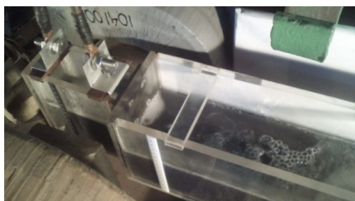
Рисунок 5 Работа модели с алюминиевыми электродами
