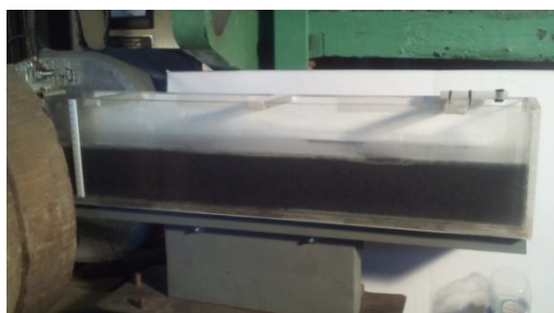
Рисунок 4 Обработка расплава медными лужеными электродами
