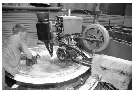
Рисунок 9 Процесс автоматической наплавки с дополнительной холодной присадочной проволокой (АФНдхп) в условиях цеха
