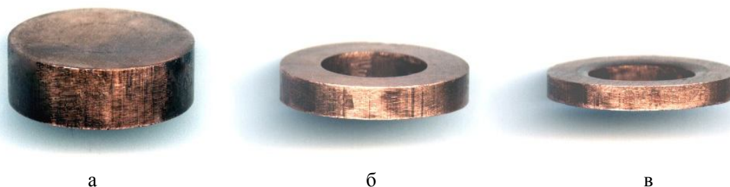
Рисунок 6 Образцы для анализа равномерности: а — донная, б — кольцевая, в — торцевая части
