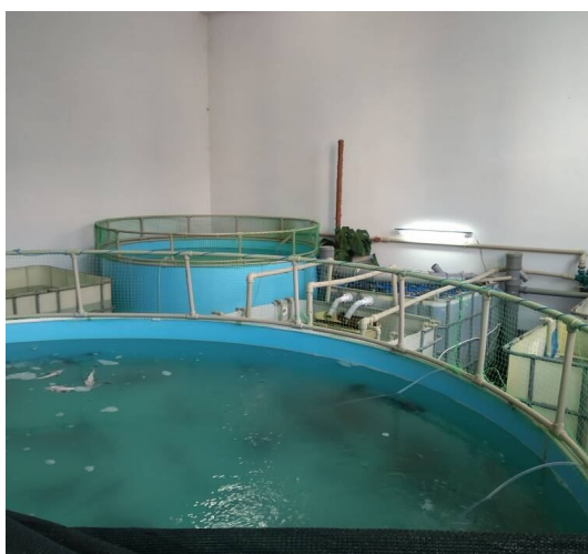
Рисунок 1 Бассейны УЗВ цеха выращивания товарной рыбы
