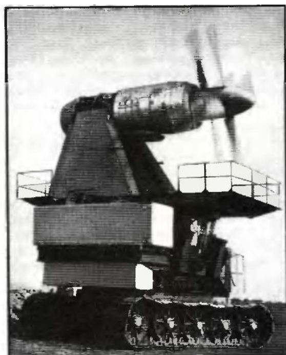
Рисунок 4 Карьерная вентиляторная установка НК-12КВ с газывыводящим соплом
