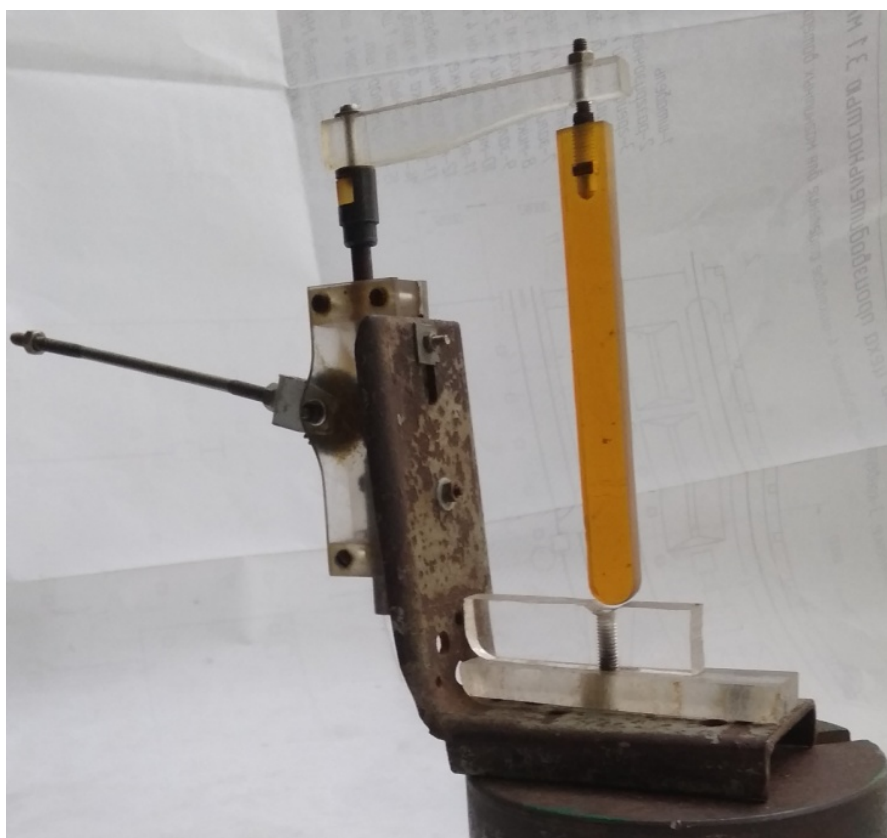
Рисунок 1 — Физическая модель стопорной системы для получения качественной картины напряжений в узле крепления ее стопора-моноблока
