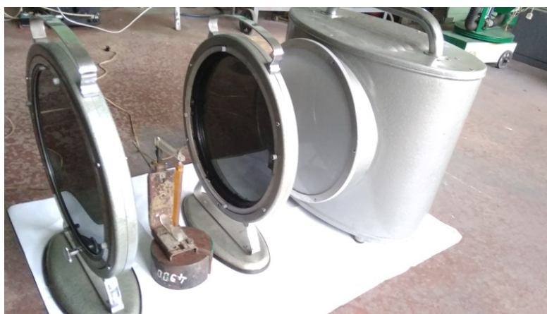
Рисунок 3 — Общий вид использовавшейся поляризационно-оптической установки
