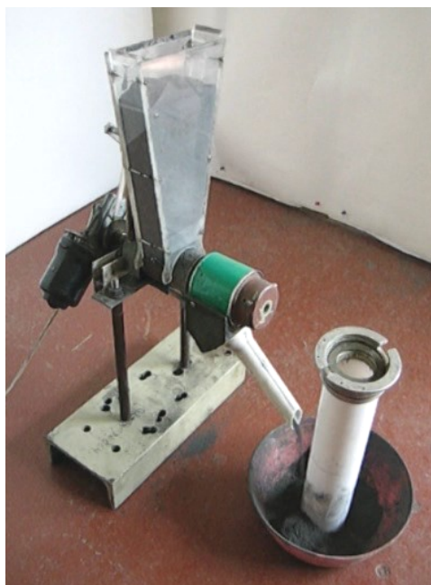
Рисунок 2 — Физическая модель предлагаемой системы механизированной подачи ШОС в кристаллизатор блюмомой МНЛЗ
