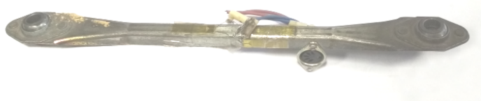
Рисунок 3 — Рычаг с размещенными на нем тензодатчиками для контроля передаваемой нагрузки
