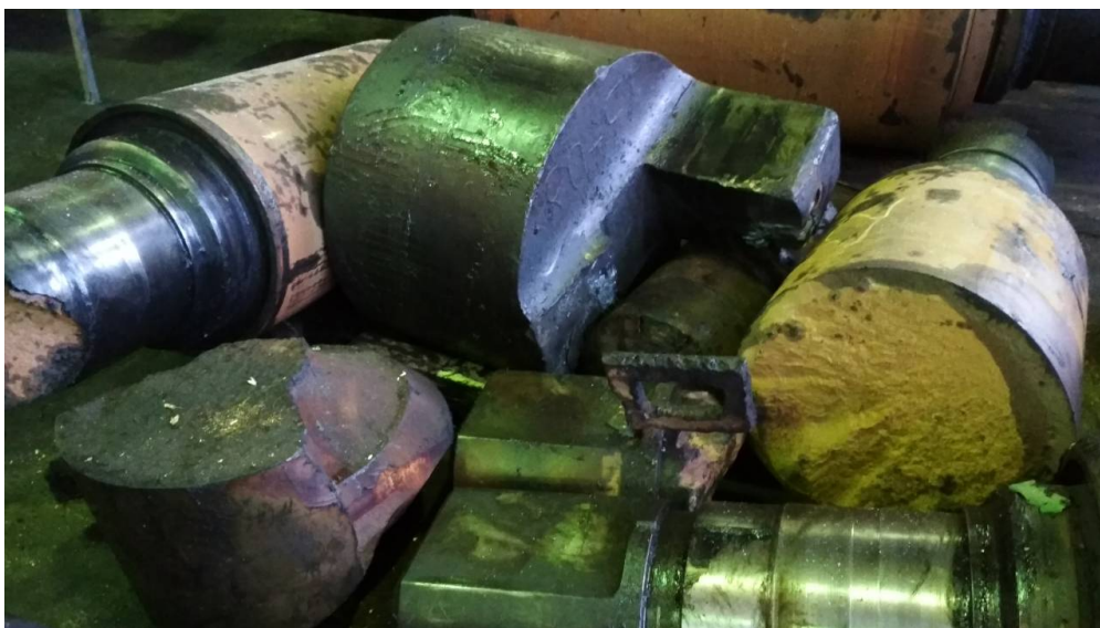
Рисунок 1 Разрушенные рабочие валки и валковые муфты стана 1700
