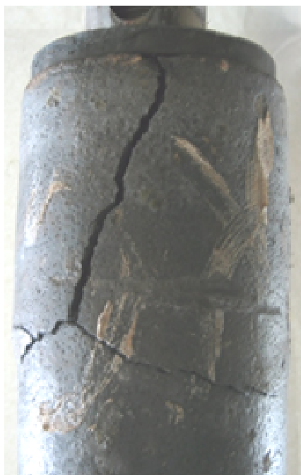
Рисунок 2 Разрушение огнеупорного стопора-моноблока в зоне узла
