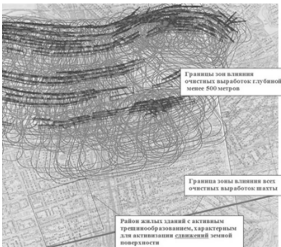
Рисунок 1 — Зоны влияния горных выработок шахты «Кочегарка» (г. Горловка)
