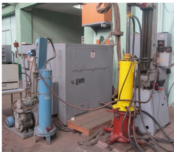
Рисунок 1 — Установка камерного электрошлакового переплава
