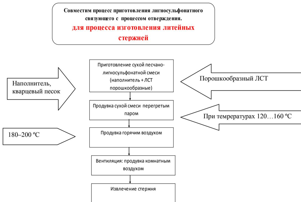
Рисунок 2 — Новый, предлагаемый алгоритм применения лигносульфонатных связующих в стержневых смесях, с использованием продувочных технологий
