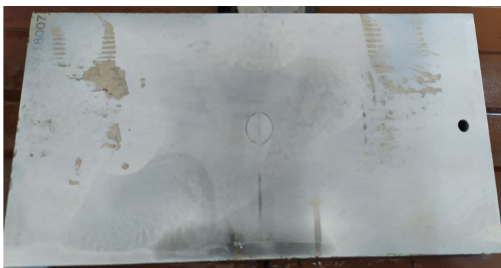
Рисунок 2 — Индикаторный рисунок дефектов образованный магнитной суспензией с применением черного магнитного порошка «Крокус»
