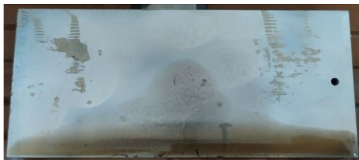
Рисунок 3 — Индикаторный рисунок дефектов образованный магнитной суспензией с применением порошка \gamma\text{-Fe}_2\text{O}_3
