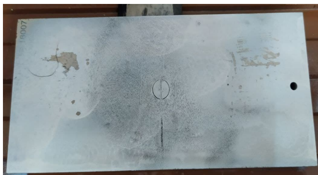
Рисунок 1 — Индикаторный рисунок дефектов образованный магнитной суспензией с применением серого магнитного порошка «Диалма»
