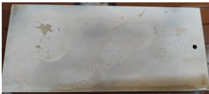
Рисунок 4 — Индикаторный рисунок дефектов образованный магнитной суспензией с применением порошка \text{Fe}_3\text{O}_4
