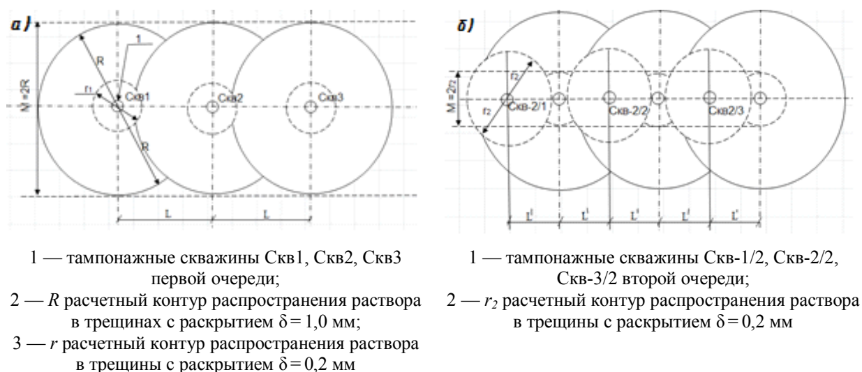
Рисунок 4 Схемы формирования противофильтрационной завесы
