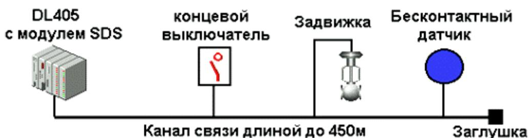
Рисунок 1.10 – Схема подключения периферийных устройств к модулю DL405
