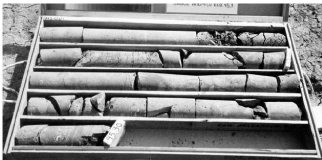
Рисунок 5.11 – Порода в виде кернов, выбуренных из скважины, для определения критерия RQD
