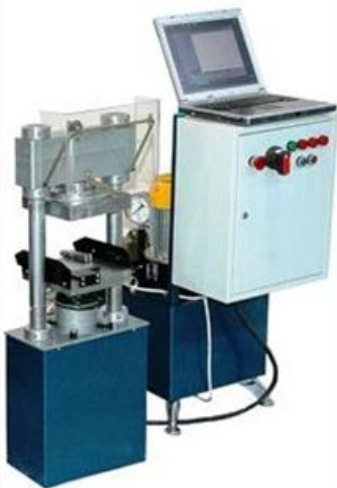
Рисунок 2.9 – Общий вид прессы на 50 кН для механических испытаний образцов напряжённого состояния конструкций, основанное на измерении местных деформаций.
