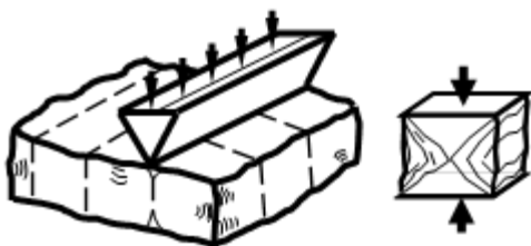
Рисунок 6.10 – Испытания на сжатие образца после раскола породной плиты
